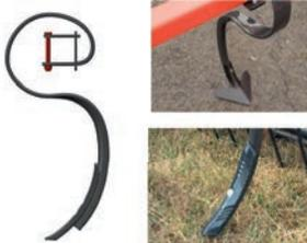
✓ **5 рядов вибрирующих S-образных стоек 70x12 мм** могут оснащаться наконечниками двух типов: стрелчатой лапкой для обработки на глубину 3-7 см или долотьями для обработки на глубину 5-12 см, и обеспечивают идеальную подготовку почвы и стерни. Стойки оснащены не требующей технического обслуживания системой защиты 3D с возможностью вертикального и бокового смещения.
