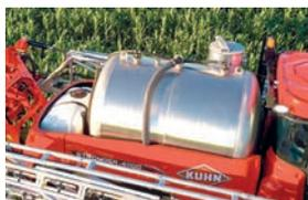
✔ **Сверхпрочный бак на 4 000 л** из нержавеющей стали обеспечивает высокую долговечность и устойчивость к коррозии, позволяет значительно более быстро и эффективно очистить бак в момент смены препарата. 4 гидромешалки обеспечивают постоянное перемешивание жидкости в баке.
