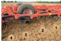
✓ **4 агрономические операции** за один проход для оптимальной работы: измельчение, глубокое рыхление на глубину и равномерное перемешивание, выравнивание, прикатывание и уплотнение.
