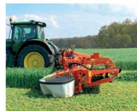
✔ Кожухи **FlexProtect** надежно защищают от повреждений в случае столкновения с препятствием.
