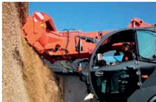
☑️ **Высокопроизводительная загрузка силоса** за счет широкой мощной фрезы (2м, 200 л.с) и высокоскоростная раздача. Фреза обеспечивает ровный срез в силосной яме, препятствующий проникновению воздуха в корм.
