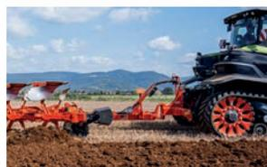
Цельная голова плуга для быстрой адаптации к любому трактору – расчетная прочность до 400 л.с.
