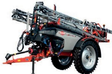
☑️ 3 000 л или 3 800 л бак специальной формы с низким центром тяжести обеспечивает максимальный слив даже на наклонных поверхностях и сохранение устойчивости в различных условиях. Промысловый бак с центральным расположением обеспечивает удобное и простое заполнение, а также минимизирует риск опрокидывания.
