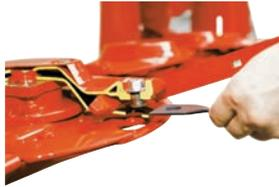
✔ Система защиты **PROTECTADRIVE** и система быстрой замены ножей **FAST-FIT** экономят время и ресурсы на обслуживание агрегата.
