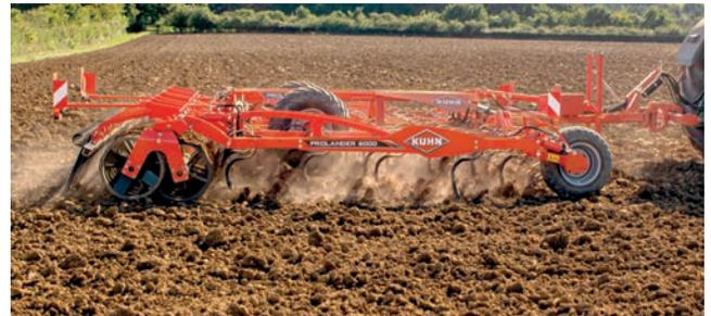
✓ **Низкое потребление мощности** 25-35 л.с./м при рабочей скорости 12 км/ч за счет шахматного размещения рабочих органов.
