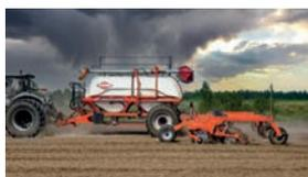
Глубина сева до 10 см с минимальной нагрузкой на трактор. Сеялка агрегируется с тракторами от 300 л.с.
