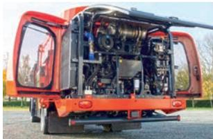
☑️ Производительность, маневренность, комфорт вождения и низкий расход топлива с **6 цилиндровым двигателем VOLVO** (7,7 л/ 250 л.с) с турбонадувом.
