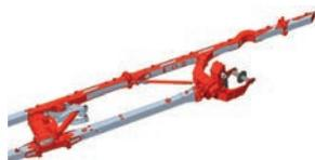
Усиленная стальная рама с сечением 180\*180 мм с двойной толщиной стали на нагруженных участках. Регулировка глубины алюминиевыми клипсами обеспечивает быструю настройку и долгий срок службы.
