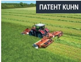
✔ Ширина сгруппированного валка регулируется от 180 до 360 см (самый широкий диапазон в отрасли) гидравлически в непрерывном режиме из кабины трактора. Идеально подходит для адаптации к различной ширине дальнейшей кормоуборочной техники.
