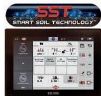
**Функция SMART SOIL TECHNOLOGY**, используя технологию ISOBUS, позволяет из кабины трактора регулировать рабочую глубину, угол атаки передней и задней секций, давление прикатывающей системы Star Wheel™ и выравнивание передней и задней секций.
