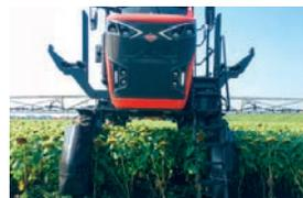
✔ **Самоходный опрыскиватель с клиренсом 1,8 м** (один из самых высоких в мире) для обработки как низкорослых, так и высокостеблевых растений. Это позволяет на 5-10% уменьшить повреждение растений и повышает урожайность. Пластиковая защита колес и днища.
