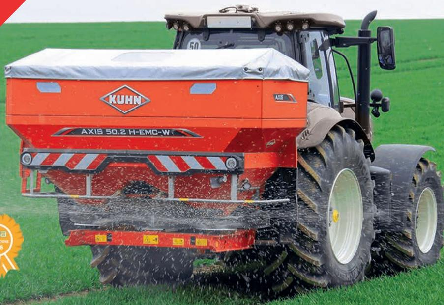
**ELECTRONIC MASS FLOW CONTROL (EMC)** – эксклюзивная система высокоточного независимого регулирования потоков удобрений для левого и правого дисков в каждый момент времени не имеет аналогов в мире. Риск забивания, даже при низких дозах, отсутствует.
