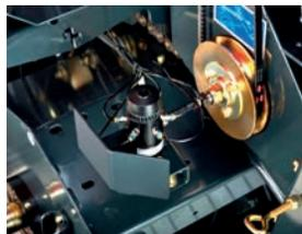
☑ Система непрерывной смазки цепи БЕКА-МАХ с резервуаром 8 литров сокращает время ежедневного обслуживания.
