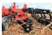
**Эксклюзивная прикатывающая система Star Wheel™** (патент KUHN) великолепно измельчает комки, выравнивает почву и закрепляет пожнивные остатки в почве. Прикатывающий каток 24/7® завершает подготовку семенного ложа.
