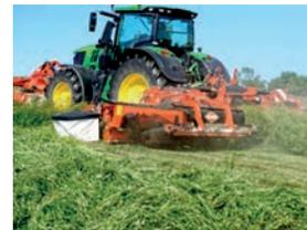
✔ Гидравлическая система защиты **NON STOP** и активная система отведения непрерывного действия обеспечивают безопасность при столкновении с препятствием.
