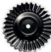
**Качественное измельчение и заделка** пожнивных остатков на большой скорости благодаря 2 батареям уникальных самозатачивающихся дисков Excalibur® с 32 канавками (патент KUHN), расположенным с шагом 18 см передняя батарея и 20 см задняя.
