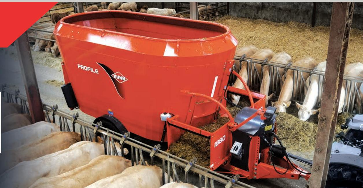
Надежные прицепные смесители-раздатчики полнораціонных кормов с 2 вертикальными шнеками объемом от 14 до 30 м<sup>3</sup>.
